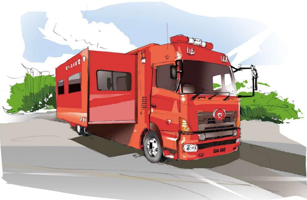
東北に出動した長野市消防局の「緊急消防隊後方支援車」(拡幅時)。
