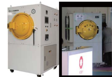
左が羽生田鉄工所が開発製造したCFRP成形用の圧力加工装置「オートクレーブ」。右は某国製のそっくりさん
